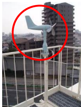
名神架道橋上風向風速計発信器
